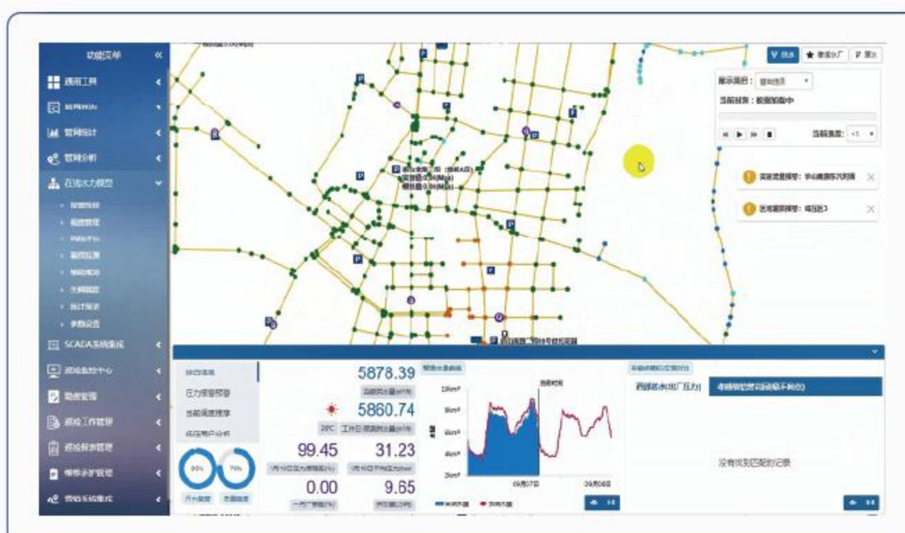
供水管网水力模型系统
